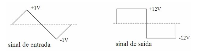
(13) Circuito Comparador de Tensão. Explique a operação do circuito a seguir. Expresse graficamente, com valores, a saída  $V_o$ . Considere  $V_P = V_{CC}$ . Considere o amplificador operacional ideal.
