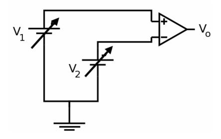
(19) Apresente uma aplicação prática para o circuito mostrado na figura a seguir. Complete-o na sua saída. Observe que o amplificador operacional opera com polarização unipolar. Neste caso, podemos usar o amplificador operacional LM324.
