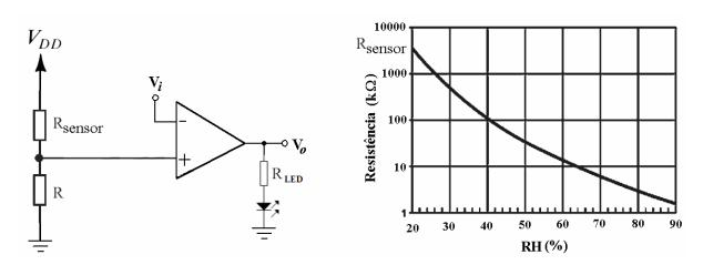
**(b)** Complete o circuito acrescentando um divisor de tensão resistivo determinando os valores de  $R_1$  e  $R_2$  capazes de fornecer a tensão  $V_i$  necessária para atingir a condição desejada, ou seja, acender o LED sempre que a umidade relativa do ar for igual ou superior a 40 %.
