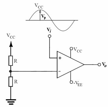
(14) Considere  $V_i(t) = V_P sen 2\pi 10^3 t$ . Por quanto tempo permanecerá o LED verde aceso para cada ciclo da entrada senoidal? E o LED azul? Considere  $V_P = V_{CC}$ . O amplificador operacional opera em malha aberta ou malha fechada? Justifique.
