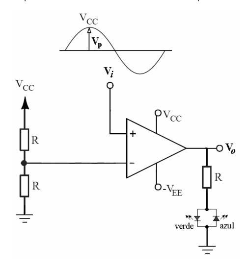
(15) Determine o valor de  $V_o$  e da corrente pelo resistor  $R_2$  para os diversos valores de  $R_2$ .
