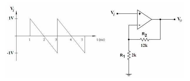
(8) Determine a corrente de saída  $I_{\text{o}}$  para o amplificador operacional mostrado no circuito a seguir.
