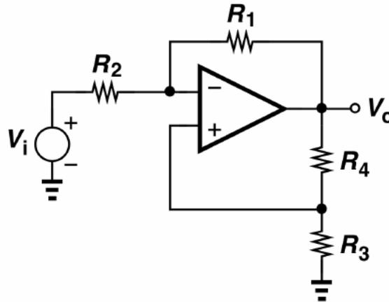
(6) Mostre que os circuitos a seguir possuem uma impedância equivalente a um **indutor L** em **série com um resistor R**. Determine os valores de **L** e **R**.
