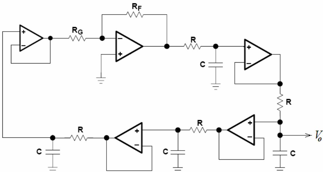
(5) Suponha que sua primeira tarefa como estagiário em uma indústria de equipamentos eletrônicos seja projetar um *oscilador senoidal* para servir de referência *na afinação de instrumentos musicais*. Foi solicitada a montagem de um oscilador senoidal, conforme circuito mostrado na figura a seguir, capaz de reproduzir a nota musical **LÁ** ( $A = 440 \text{ Hz}$ ).
