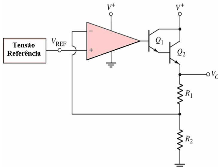
**(3) FONTE DE TENSÃO REGULADA** – O circuito a seguir é utilizado quando se deseja aplicar uma *tensão constante*  $V_o$  sobre uma carga qualquer  $Z$ . Determine o valor da expressão para a corrente  $i$ . Mostre que a tensão  $V_o = kV_Z$  *independe da impedância*  $Z$ . Determine o valor de  $k$ .
